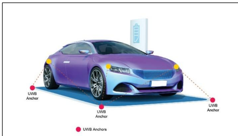
汽车无线充电- 充电线圈自动定位系统
